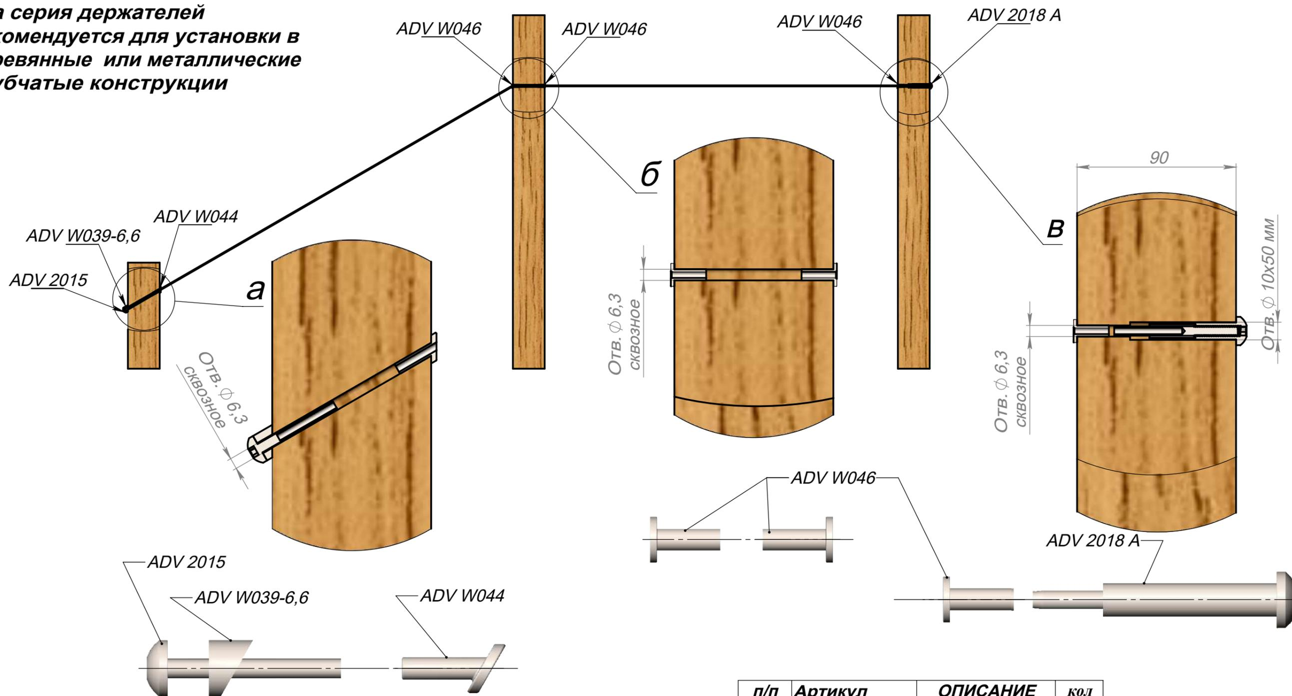
\* Длину троса определять с учетом концов на опрессовку (60 мм) и его натяжение (до 20 мм)
